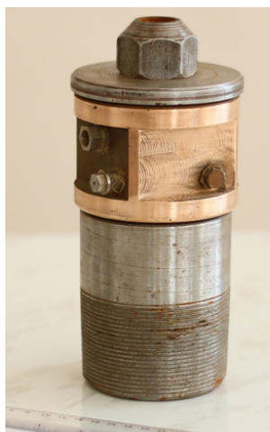
Рис. 3. Ротационный вибратор, совмещенный со струйным насосом
