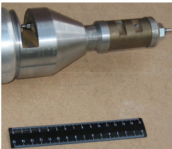
Рис. 2. Роторный гидродинамический кавитационный вибратор
